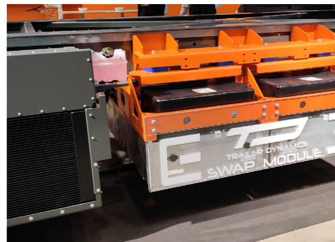
Abbildung 5: Battery Swapping Station des e-Haul Projektes sowie Prototyp des Swapping-Moduls für Trailer von Trailer Dynamics (Bildquellen: TU Berlin, Sustainable Truck&Van)
