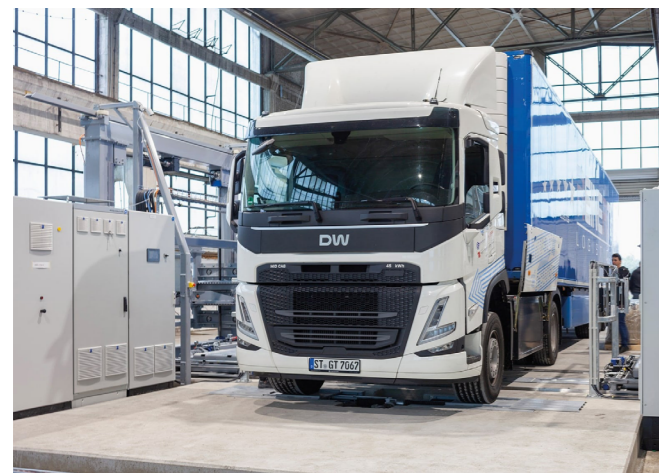
Abbildung 5: Battery Swapping Station des e-Haul Projektes sowie Prototyp des Swapping-Moduls für Trailer von Trailer Dynamics (Bildquellen: TU Berlin, Sustainable Truck&Van)
