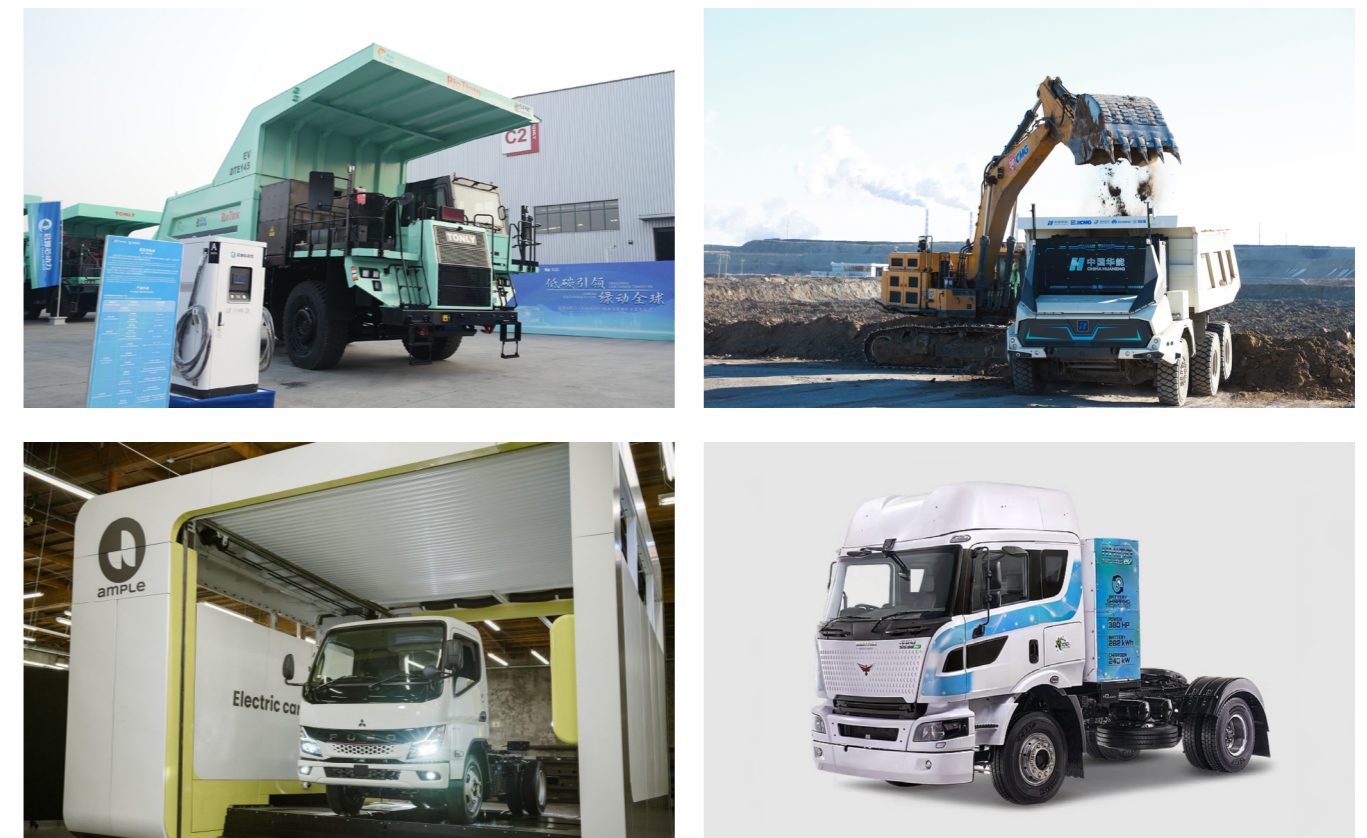
Abbildung 4: Beispiele internationaler Entwicklungen im Bereich Battery Swapping schwerer Nutzfahrzeuge (Bildquellen: Rio Tinto, Huawei, Montra Electric, Mitsubishi) (im Uhrzeigersinn)
